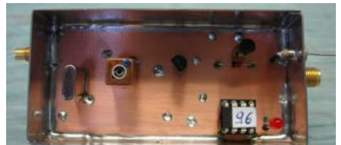
Die LED leuchtet wenn die PLL eingerastet ist.
