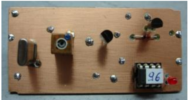
Quarz und Spule konnten aus dem Oszillator gewonnen werden. MC TINY 13 mit Programm für 96 MHz.
