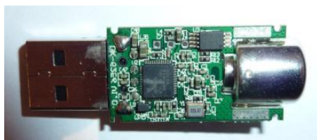
RTL USB Chip inkl. 8Bit A/D Wandler I/Q Stream USB2.0
