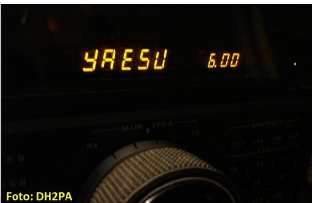
Zum Prüfen der installierten Firmware einfach die Bandtasten 1.5 und 7 gleichzeitig drücken und dabei das Gerät einschalten. Die Versionsnummer erscheint dann nach dem Displaytest.
